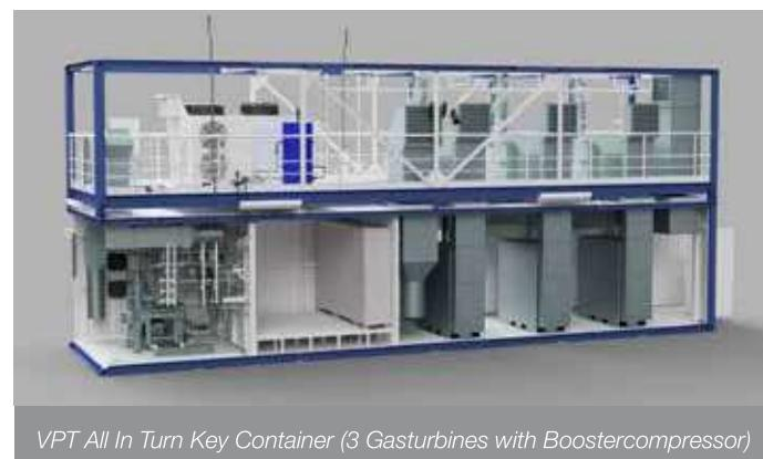
VPT All In Turn Key Container (3 Gasturbinen mit Boostercompressor)
