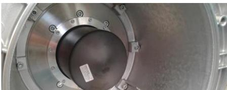
[Bild 1 Magnetkupplung – Keramikspalttopf Kompressor]
